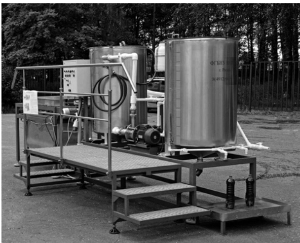
Рис. 2. Технологическая линия для производства жидких гуминовых удобрений из торфа. Технические характеристики: производительность, л/смена — 1500–2000; габаритные размеры, м: длина — 6,5, высота — 2, ширина — 2,8; масса, кг — 1200; суммарная мощность электроприводов, кВт — 10,8; обслуживающий персонал, чел. — 2
